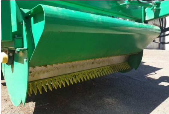
Exemple de prototype avec rotor à dent
